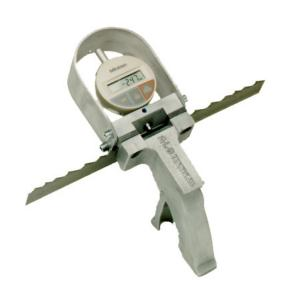
这是每一个分齿机操作员理想的分齿量测量工具。 其拥有信赖可靠的设计及一个容易握住的手枪状把 手。该测量仪由铝材制成,所有的磨损部件都是碳 化钨材质.
